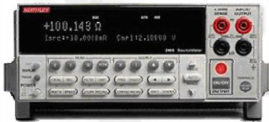
Um die Anforderung an die Messgenauigkeit zu erfüllen, wurden Multimeter der Fa. Keithley verwendet. Ausgestattet mit Multiplex Karten wird aus dem einzelnen Messkanal eine Reihe von 32 Messkanälen pro Gerät erzeugt.
