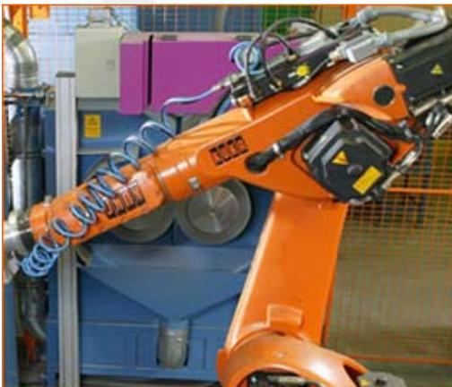
Um die Roboter-Steuerung weitgehend zu entlasten wurden rechenintensive Operationen in die am selben Rechner laufende Soft-PLC ausgelagert. Für den Programmablauf wurde ein bewährtes System eingesetzt, das jeweils den nächsten erforderlichen Arbeitsschritt ermittelt. Dadurch ergibt sich eine höchst mögliche Ablaufdynamik. Mit Hilfe der beiden Greifer ist es möglich, der Einpresstation ein Fertigteile zu entnehmen und diese sofort wieder mit einem Rohteil zu bestücken.
